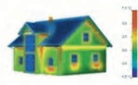
Figura sopra. Termografia di un edificio
