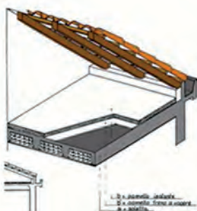
Figura 2. Isolante all'estradosso dell'ultima soletta.
