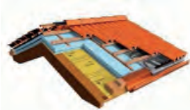
Figura 1. Tipo di isolamento termico ventilato del tetto
